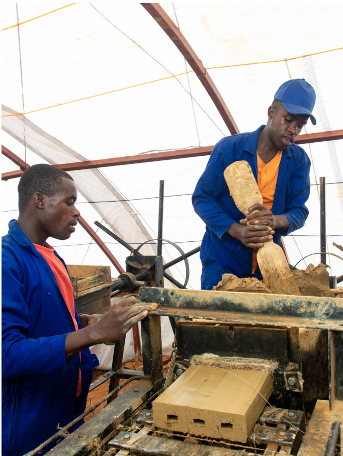
Démonstration de l'alimentation de la boîte d'argile d'une extrudeuse manuelle
