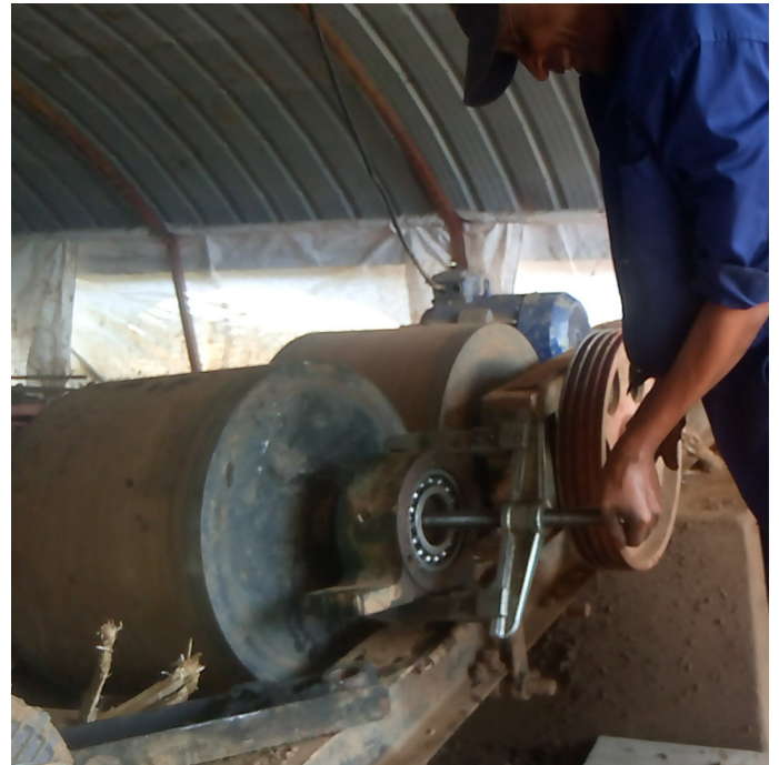
Montage d'un roulement du broyeur
