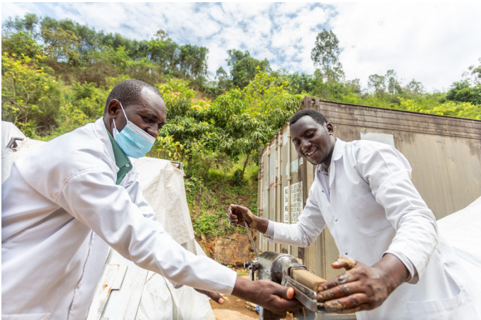
Extrusion de mini-briques
