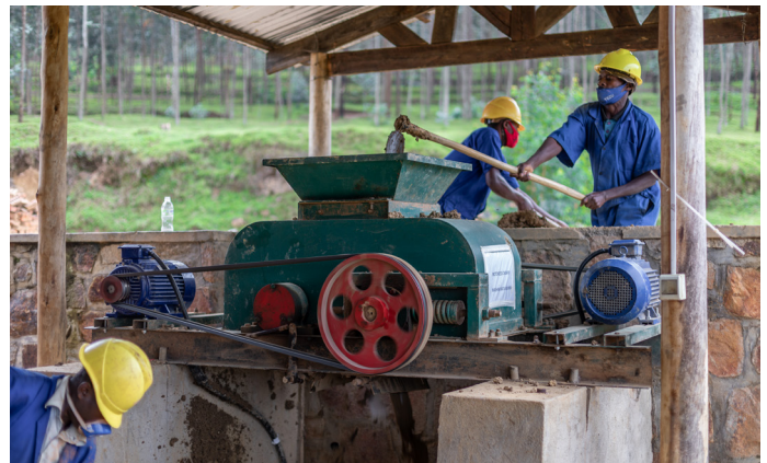
Broyage de l'argile à l'aide d'un broyeur électrique à double tambour
