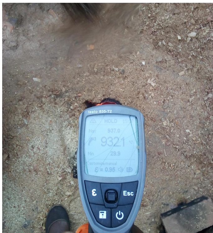
Contrôle de la température de cuisson à l'aide d'un Thermomètre pistolet
