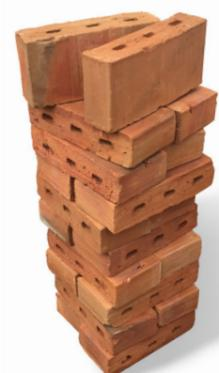
Une brique produite industriellement ou semi-industriellement avec des dimensions constantes et une résistance à la compression fiable.
