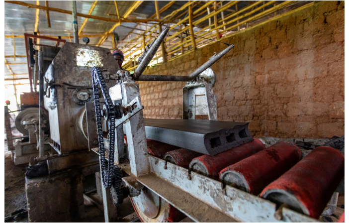
Colonne de briques pendant l'extrusion et le moulage
