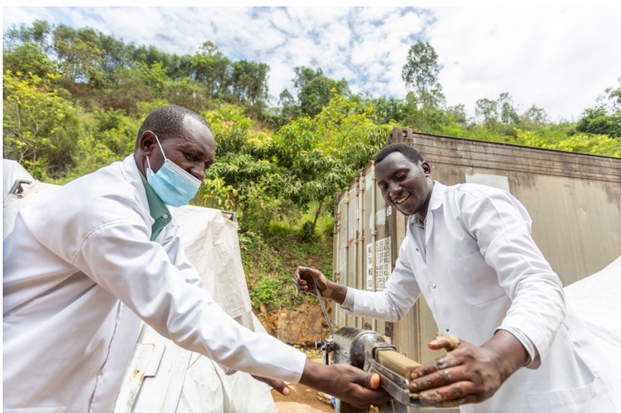
Extrusion de mini-briques
