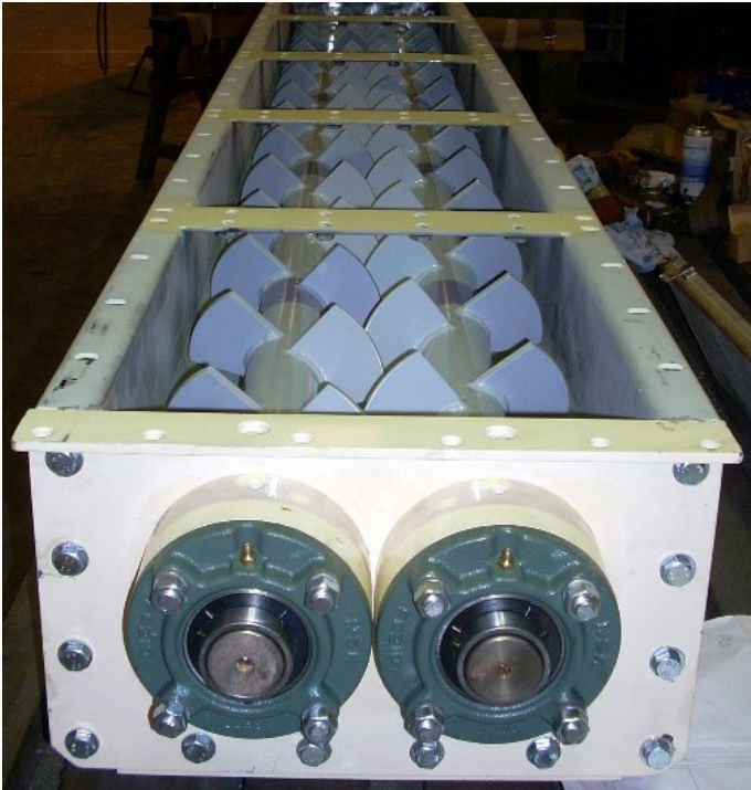
Vue des aubes à l'intérieur du mélangeur à double axe
