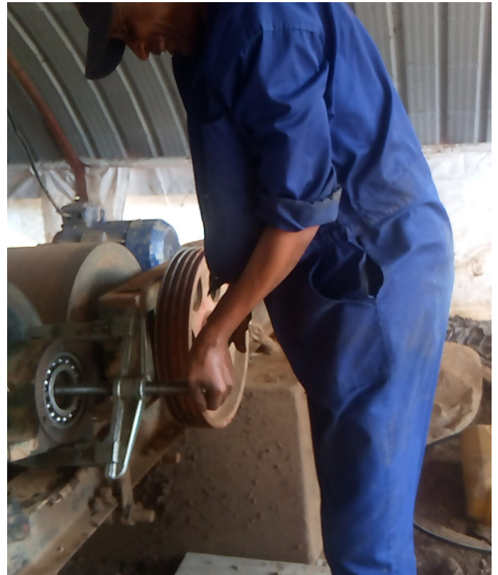
Montage d'un roulement du broyeur
