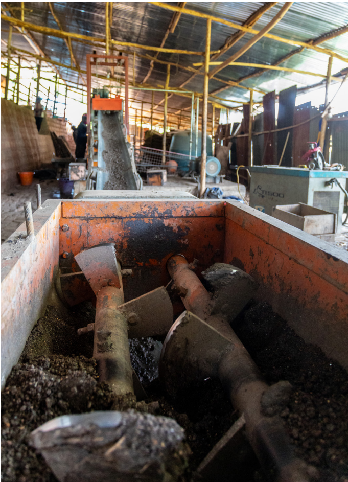
Matière première broyée et mélangée entrant dans l'extrudeuse
