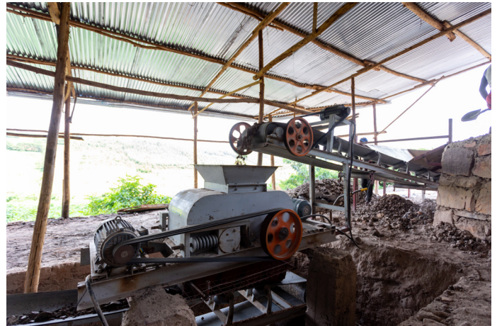
Colonne de briques pendant l'extrusion et le moulage
