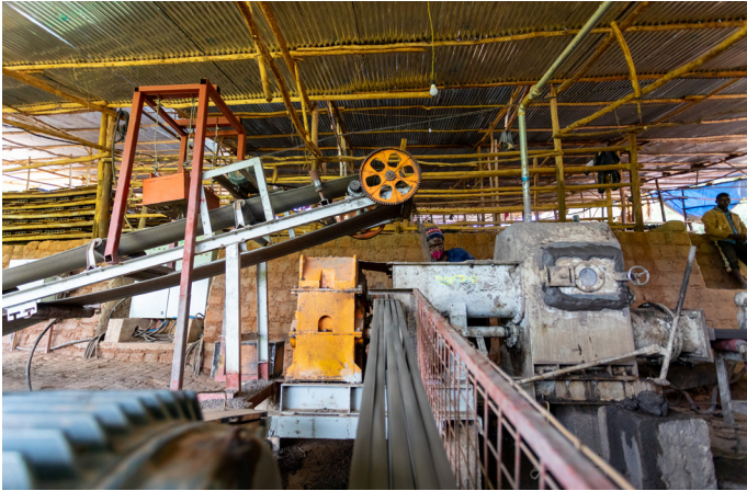
Matière première broyée et mélangée entrant dans l'extrudeuse
